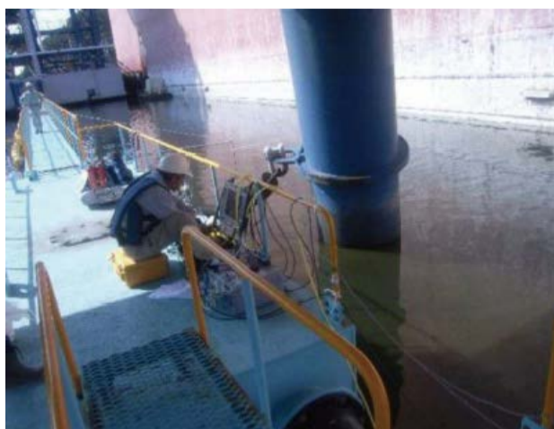
貯蔵船船体外板の腐食電位の測定
